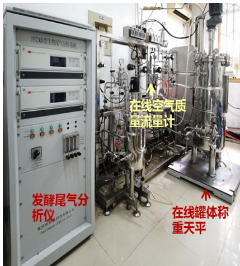
比耗氧速率 ( qO_2 ) 实时测定发酵罐
